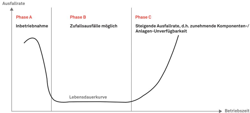
Die Erfahrung zeigt, dass die Phase C nach ca. 20 Betriebsjahren beginnt und sich bei 40 Betriebsjahren und mehr eine drastische Erhöhung von Ausfällen zeigt. Der sicherste Zustand besteht im Zeitraum B, in dem die Frühausfälle abgeklungen sind und dem Zeitraum, in dem die Ermüdungsausfälle sich noch nicht bemerkbar machen.
