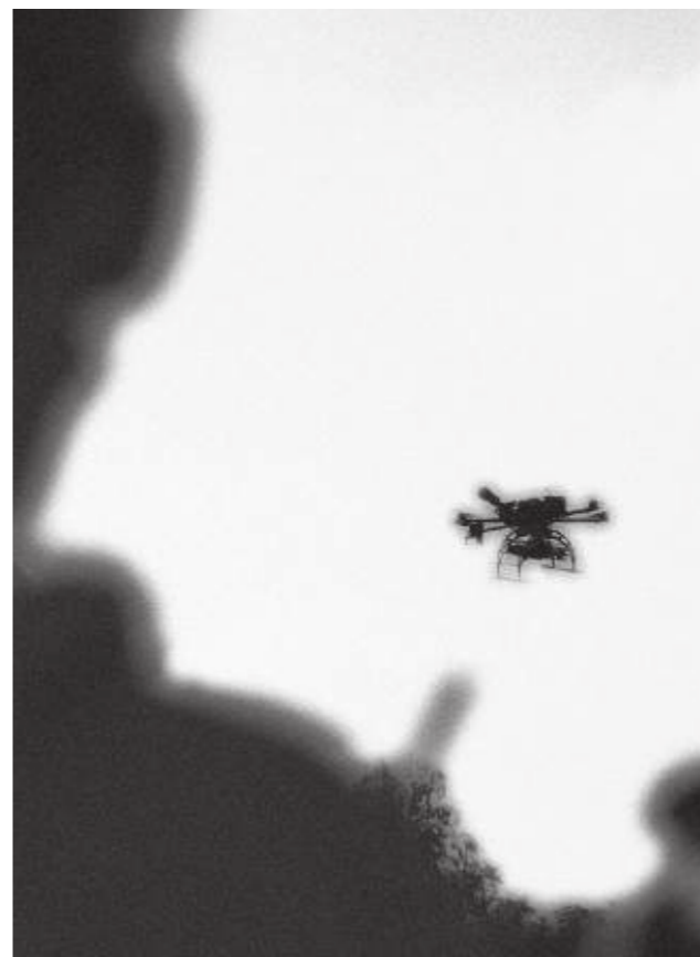
Modernste Technik: Mithilfe einer eigens für diesen Einsatz konstruierten Drohne kann die Strahlenbelastung in bis zu 100 Metern Höhe gemessen werden.
