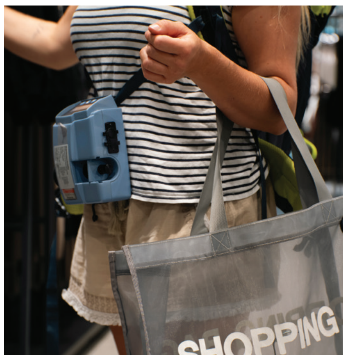
Échantillonnage de microplastiques en suspension dans l'air. Toutes les photos © Marc Meier
