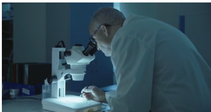
Greenpeace-Wissenschaftler Dr. David Santillo untersucht die Oberfläche eines silbernen Filters, mit dem Partikel aus der Luft gesammelt wurden, bevor die Probe mit einem Infrarotmikroskop auf Mikroplastik untersucht wird. Foto ©Jack Taylor
