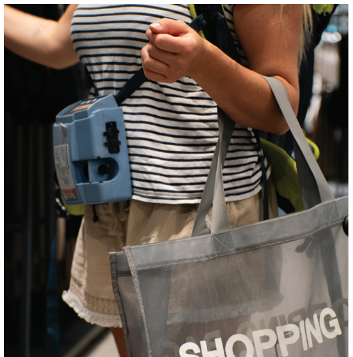
Probeentnahme von Mikroplastik aus der Luft. Alle Fotos © Marc Meier
